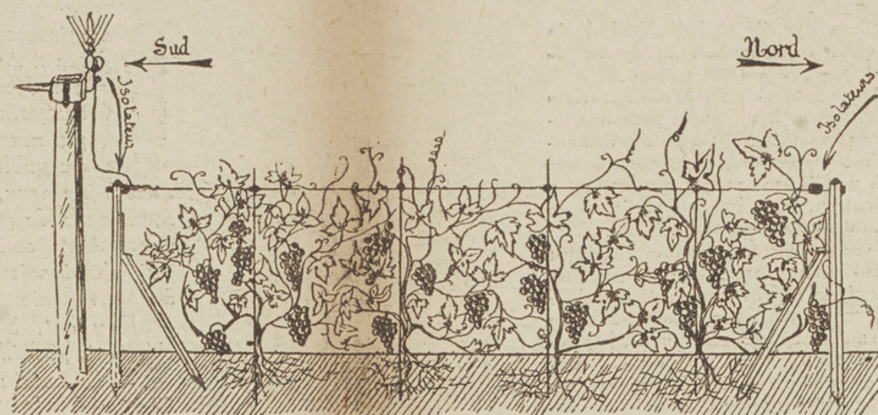
Electrification d'un rang de vignes ou d'arbres.
